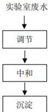
图 4-2 污水处理站工艺流程图
