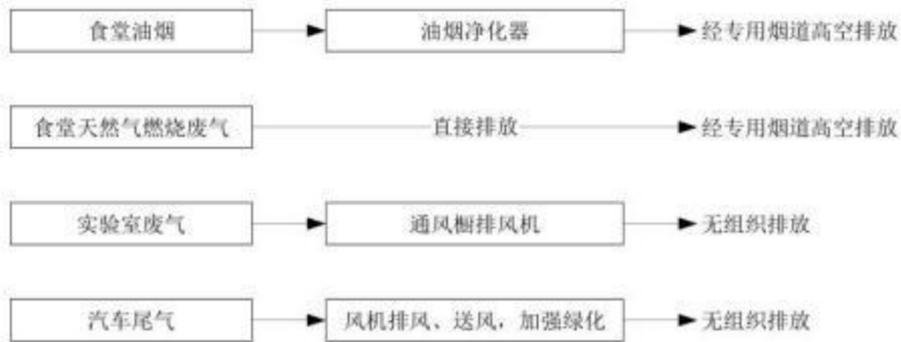
图 4-1 本项目废气处理工艺流程图
