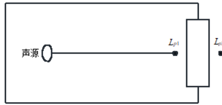
图 4-2 室内声源等效为室外声源图例
