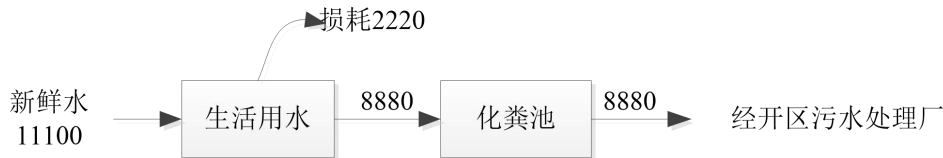
图 4-7 本项目建成后全厂水平衡图
