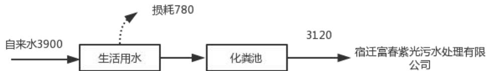
图 4-1 项目水平衡图
