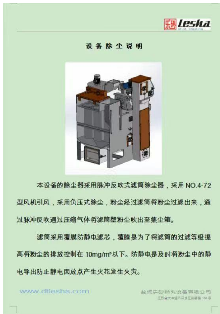
图 4-2 喷砂机配套滤筒除尘器说明图
